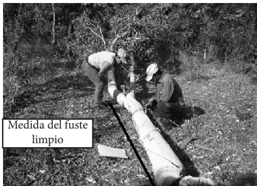
Figura 2. Medición de diámetros y longitud del fuste limpio de los árboles tumbados de Eucalyptus camaldulensis en la Finca El Plantel, 2011.
