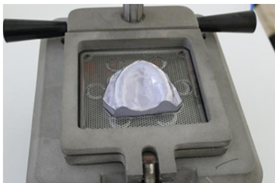
Figura 3. Máquina de vacío para construir BT de PVC
