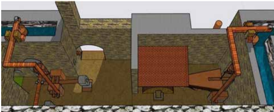
Distribución espacial de maquinaria al interior del ingenio de hierro. De izquierda a derecha: Caída de agua, noria, martinete y yunque, horno y fuelle. Elaborado por: José Orión Castellón Frech, 2021.
