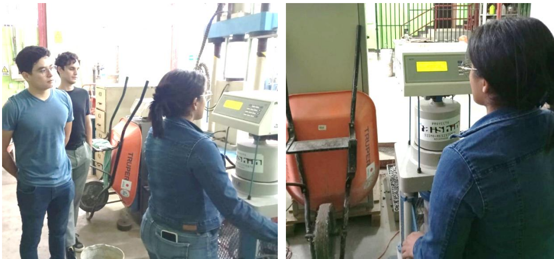
Figura 2. Ensayos a compresión de especímenes de concreto.
