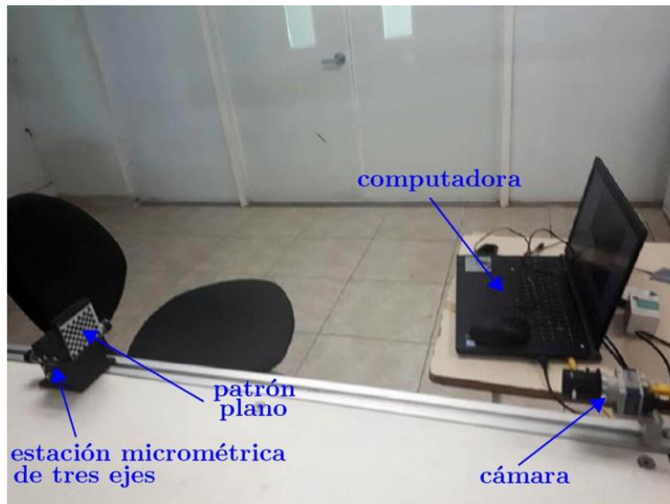
Figura 5. Configuración del experimento para la caracterización del sistema de medición.
