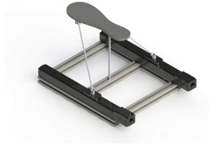
Figura 6. Diseño preliminar del robot paralelo para la rehabilitación del tobillo.
