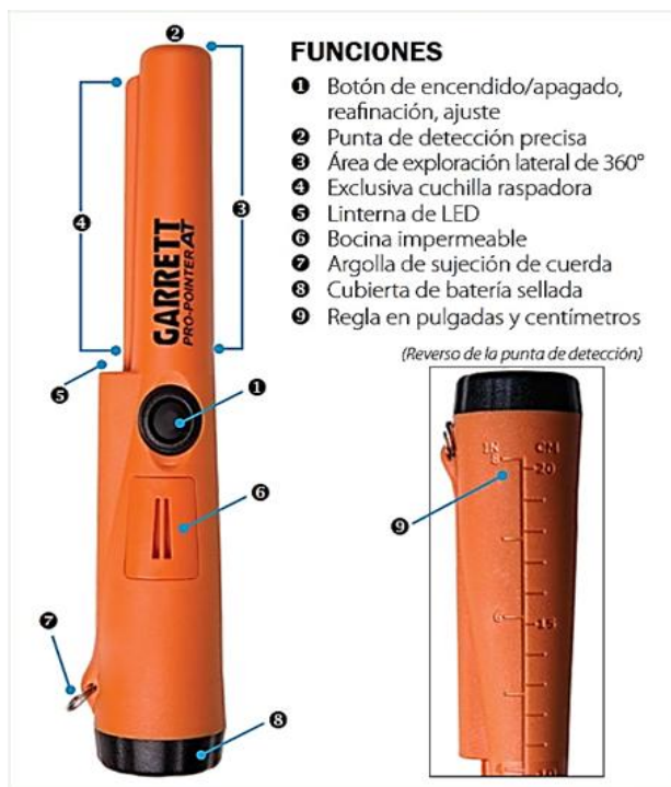
Figura 1: Características de operación, partes y especificaciones del DUPEMC. El Pro-Pointer AT de Garrett® es fabricado en Estados Unidos, modelo: Garrett Pro-Pointer® AT Número de modelo: 1140900, para ver características ingresar a: https://garrett.com/es/deporte/pro-pointer/pro-pointer-at
