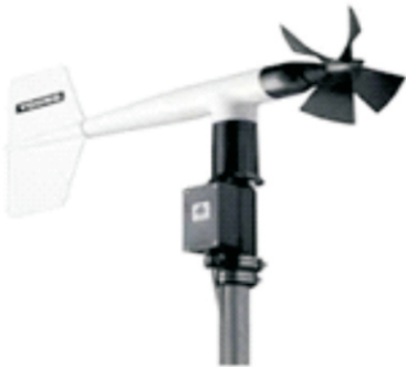
Imagen 1. Veleta para medir dirección y velocidad
