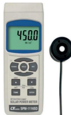
Figura 1. Imagen de referencia del instrumento utilizado. Metro solar digital
