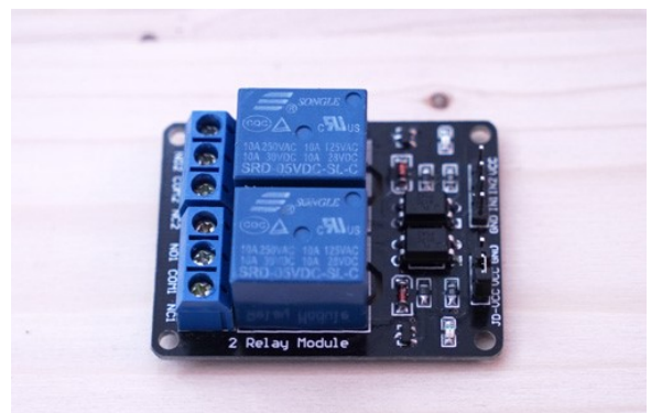
Figura 4. Relé de 12 voltios, para actividad el mecanismo de encendido de la Bomba.
